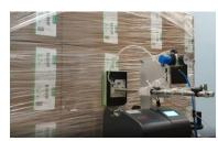
Для автоматической агрегации на паллету используется принтер-аппликатор Novexx с пневмопереносом самоклеящейся этикетки.
