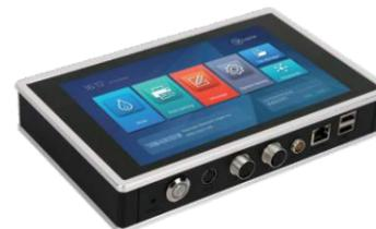
Система пьезоструйной печати высокого разрешения на базе контроллера Yeacode серии 81 объединяет в себе: одну печатающую головку Yeacode (8A, 8B, 8C или 8D) и устройство для отверждения чернил (состоящее из УФ-светодиодной лампы и УФ-контроллера). Контроллер оснащен различными аппаратными интерфейсами, обеспечивает необходимую настройку портов и протоколов, поддерживает работу с комплектами для разработки программного обеспечения (SDK), что гарантирует максимальную гибкость интеграции системы.
