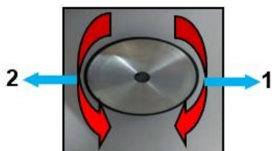
Рис. 15. Направление вращения энкодера
