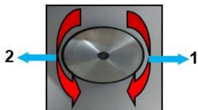
Рис. 15. Направление вращения энкодера
