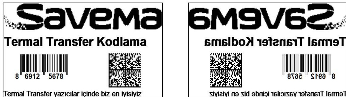
Рис. 8. Нормальная печать (слева) и зеркальная печать (справа)
