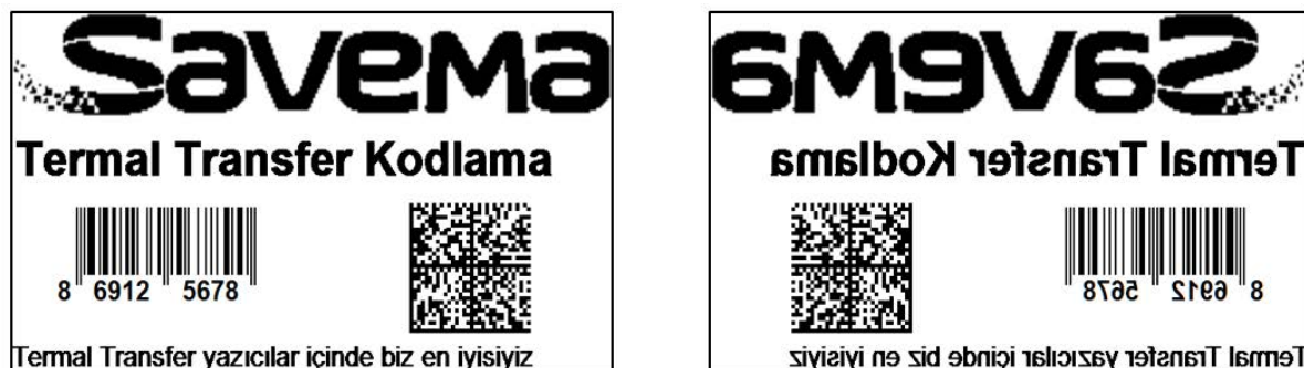
Рис. 8. Нормальная печать (слева) и зеркальная печать (справа)
