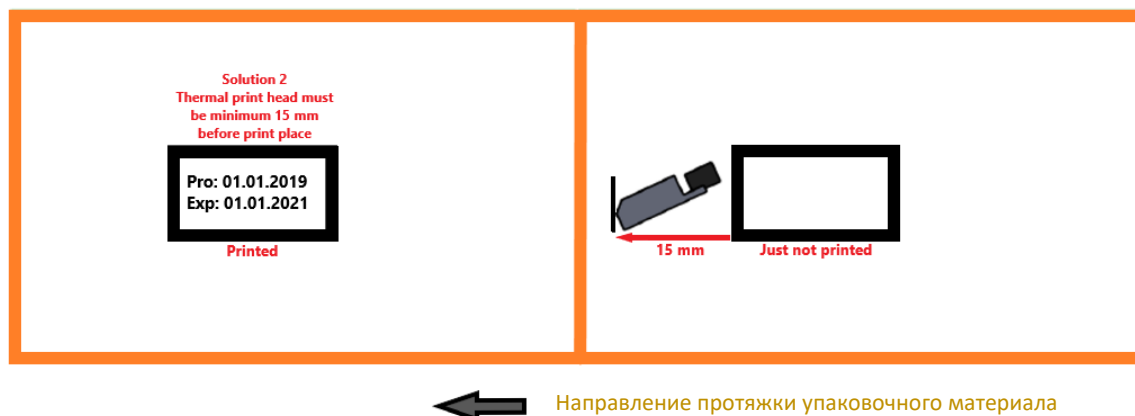
Рис. 47. Правильное положение остановки печатающей головки (Решение 2)
