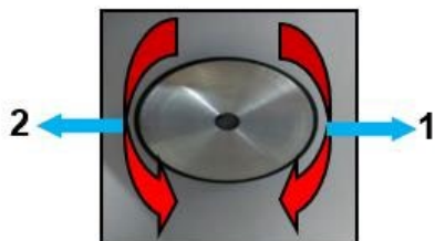
Рис. 15. Направление вращения энкодера
