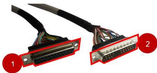
Рис. 35. Кабель связи с блоком управления Артикул: C-DATAV7-P-70
