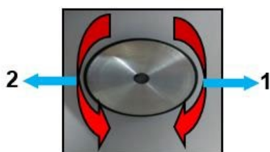
Рис. 16. Направление вращения энкодера
