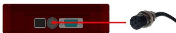
Рис. 47. Панель блока управления для подключения кабеля питания и кабеля связи принтера с блоком управления
