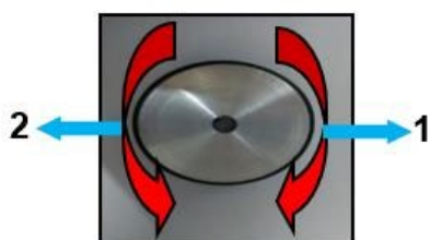
Рис. 15. Направление вращения энкодера
