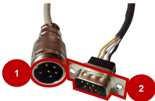
Рис. 32. Соединительный кабель энкодера Артикул: RE-DB9
