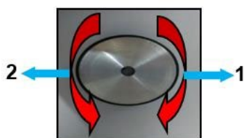
Рис. 15. Направление вращения энкодера
