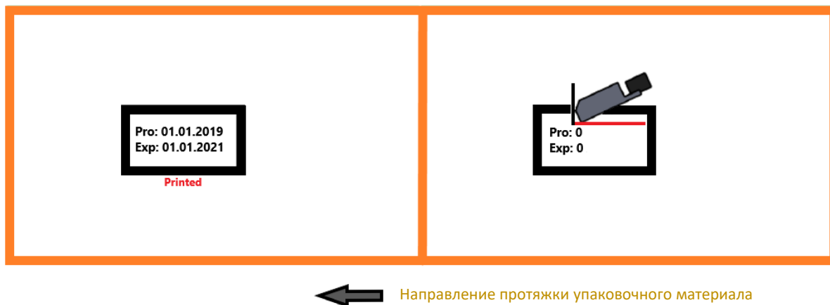
Рис. 49. Неправильное положение остановки печатающей головки
