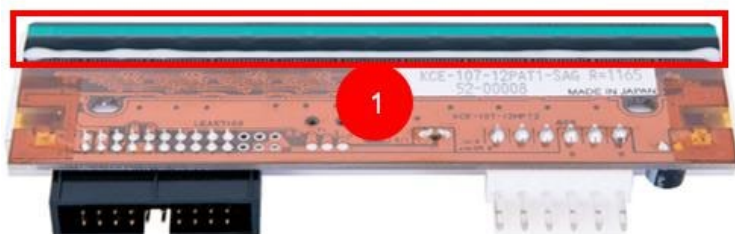
Рис. 62. Печатающая термоголовка Артикул: 200607-ТРН
