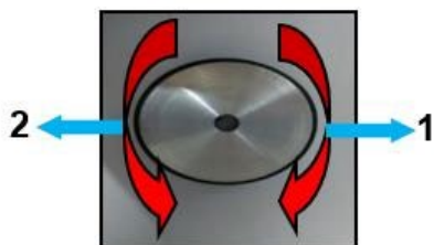
Рис. 15. Направление вращения энкодера
