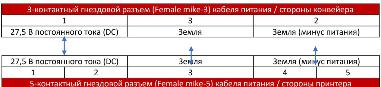
Рис. 17. Выводы разъемов кабеля питания
