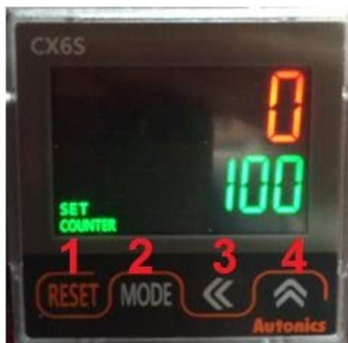
Рис. 6. Счетчик продукта / Счетчик импульсов энкодера
