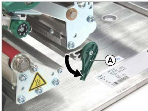
[74] Откройте крышку принтера и мягко надавите вниз на рычажок крепления (A) фотодатчика
