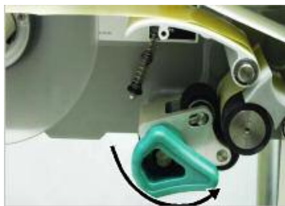
[29] Закрытие прижимного ролика.
