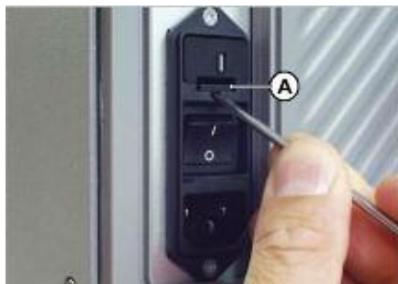
[39] Разблокировка колодки плавкого предохранителя.
