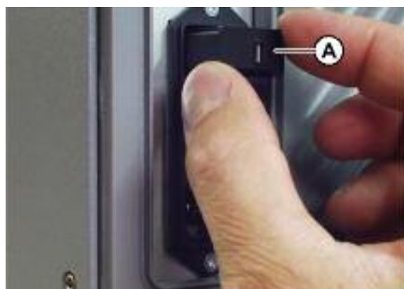
[40] Извлечение колодки плавкого предохранителя (A).
