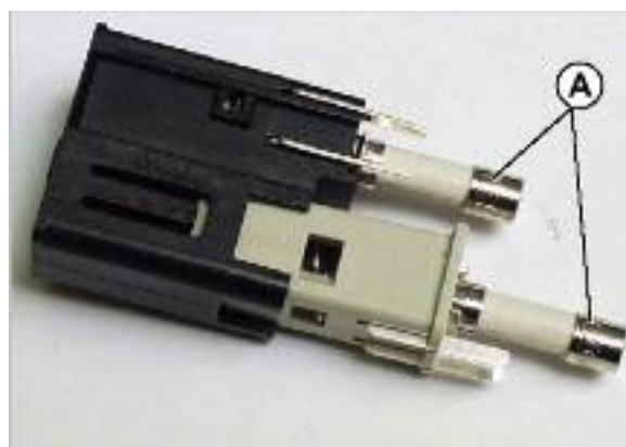
[40] Извлечение колодки плавкого предохранителя (A).
