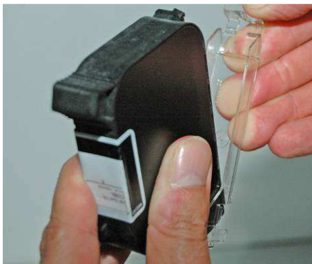
Рис. 4-1: установка картриджа HP в CartClip
