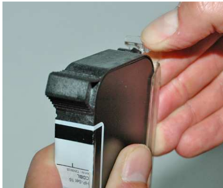
Рис. 4-2: установка картриджа HP в CartClip
