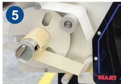
5 Намотчик подложки сматывает в рулон пустую подложку. Возможность регулировки натяжения этикеточной ленты обеспечивает плавность протяжки и стабильность разматывания и сматывания материала
