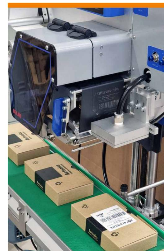
Промышленный принтер-аппликатор BEAJET комплектуется различными модулями переноса этикетки на продукт (аппликаторы). Специализированные модули переноса этикетки позволяют решать практически любые задачи по наклеиванию этикетки на продукт движущийся по конвейерной ленте.
