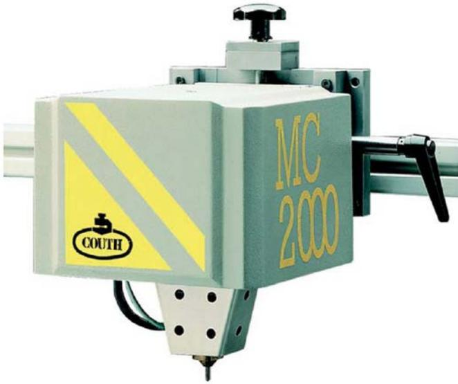
Маркиратор с большим полем печати предназначен для встраивания в производственную линию.
