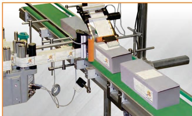
Этикетировщики серии XLS разработаны специально для бесперебойной непрерывной работы 24 часа в сутки, 7 дней в неделю с обеспечением высокой точности этикетирования. Точность позиционирования этикетки на отделяющем лезвии диспенсера автоматических аппликаторов компании Novexx Solutions серии XLS составляет  $\pm 0,5$  мм.
