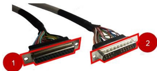
Рис. 30. Кабель связи с блоком управления Артикул: C-DATAV7-P-70
