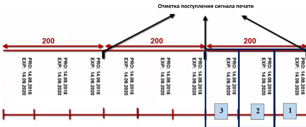
Рис. 17. Пример печати, когда функция нанесения нескольких отпечатков по одному сигналу включена
