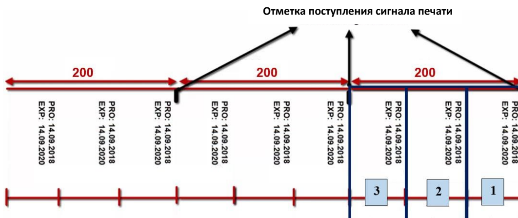
Рис. 17. Пример печати, когда функция нанесения нескольких отпечатков по одному сигналу включена
