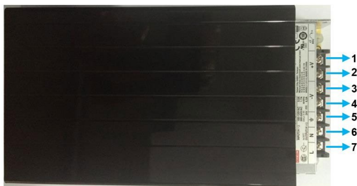
Рис. 32. Клеммы подключения на блоке питания
