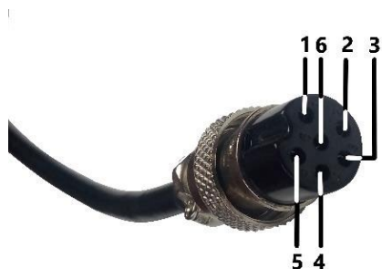
Рис. 36. Нумерация контактов разъема для подключения к блоку управления (кабель связи с блоком управления)
