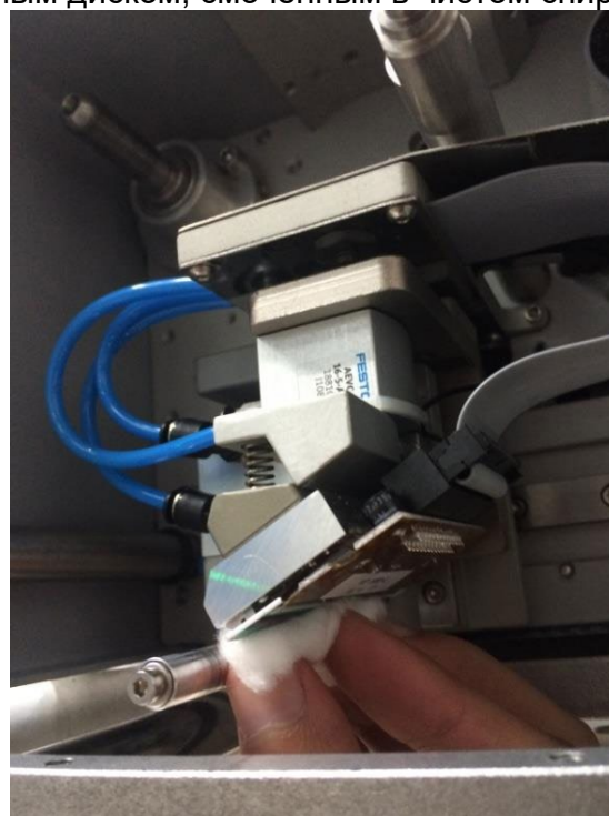
Рис. 50. Очистка печатающей головки
