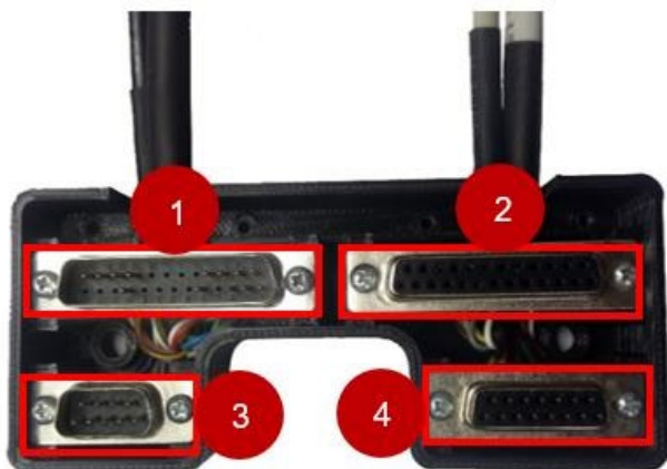
Рис. 39. Единая штепсельная вилка для кабелей принтера
