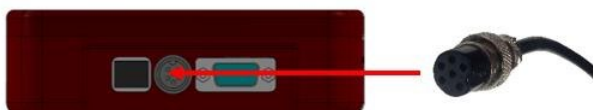
Рис. 46. Панель блока управления для подключения кабеля питания и кабеля связи принтера с блоком управления
