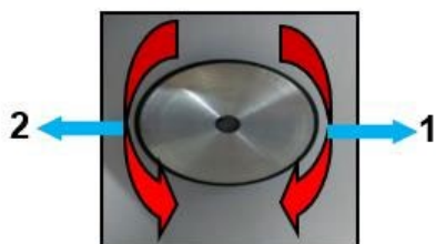
Рис. 16. Направление вращения энкодера
