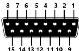
Рис. 37. Нумерация контактов гнездового разъема DB15 соединительного кабеля блока питания
