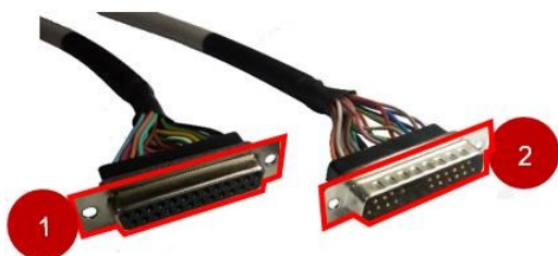
Рис. 30. Разъемы кабеля связи с блоком управления Артикул: C-DATAV7-P-70
