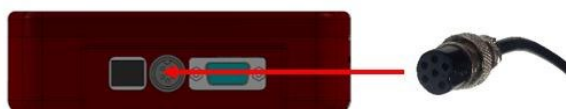
Рис. 41. Панель блока управления для подключения кабеля питания и кабеля связи принтера с блоком управления
