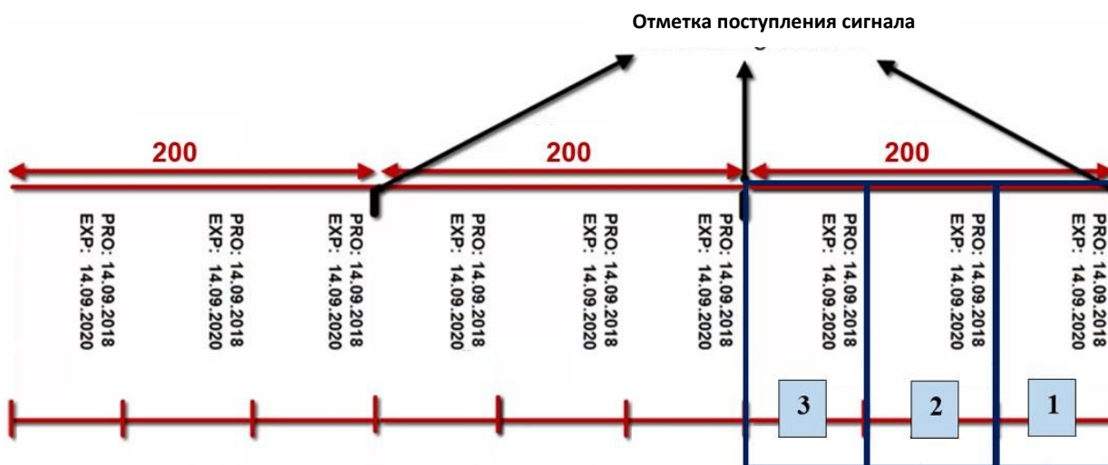
Рис. 18. Пример печати, когда функция нанесения нескольких отпечатков по одному сигналу включена
