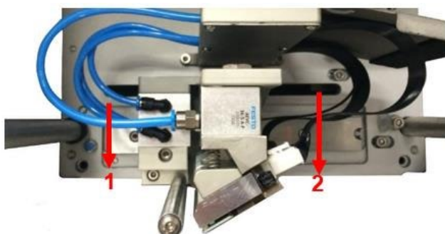
Рис. 21. Изображение ведущего вала и ходового ремня
