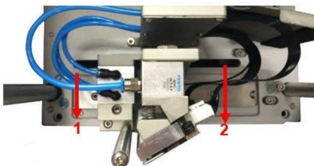
Рис. 21. Изображение ведущего вала и ходового ремня
