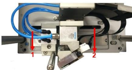
Рис. 21. Изображение ведущего вала и ходового ремня
