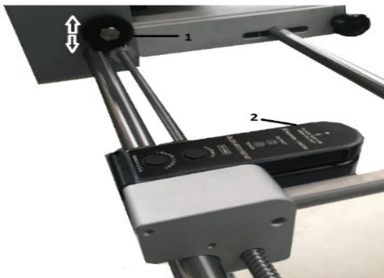
Рис. 61. Регулировка положения датчика этикетки
