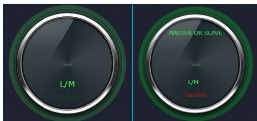
Рис. 4. Статус аппликатора в режиме «Тандем». Режим «Тандем» выключен (слева). Режим «Тандем» активирован (справа).
