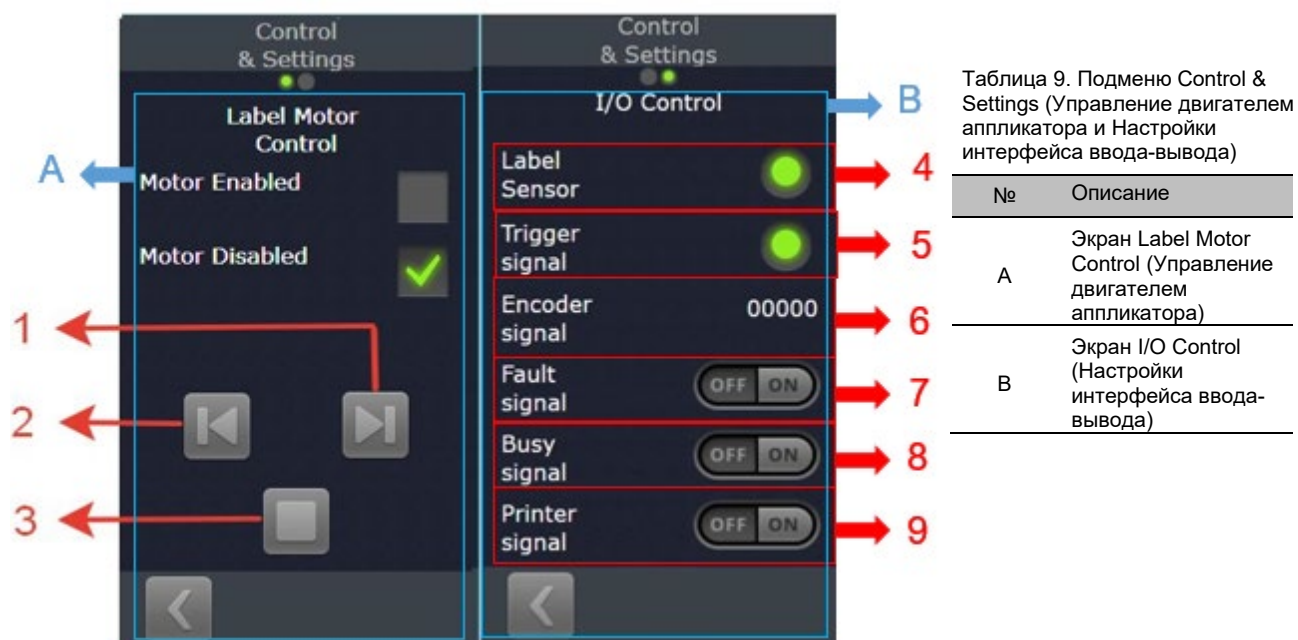
Рис. 23. Подменю Control & Settings (Управление двигателем аппликатора и Настройки интерфейса ввода-вывода)
