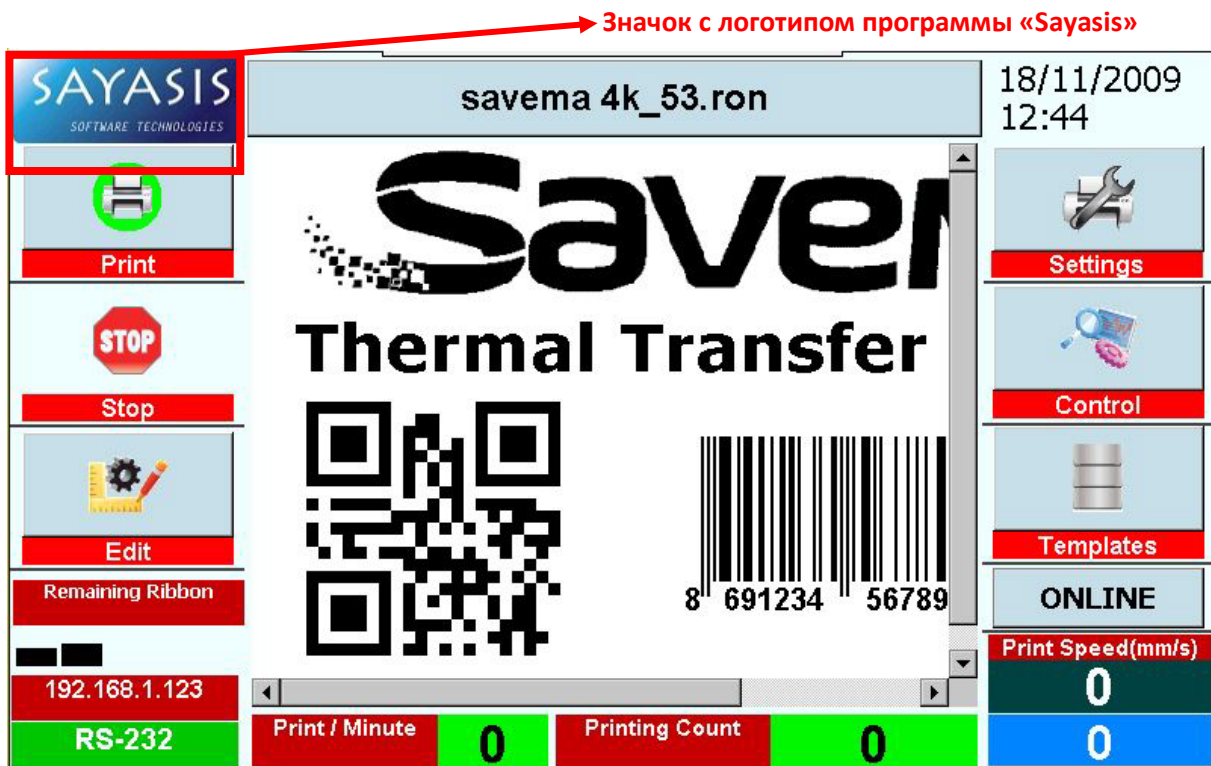
Рис. 4: Главное меню на экране блока управления системы «Savema 53C»
