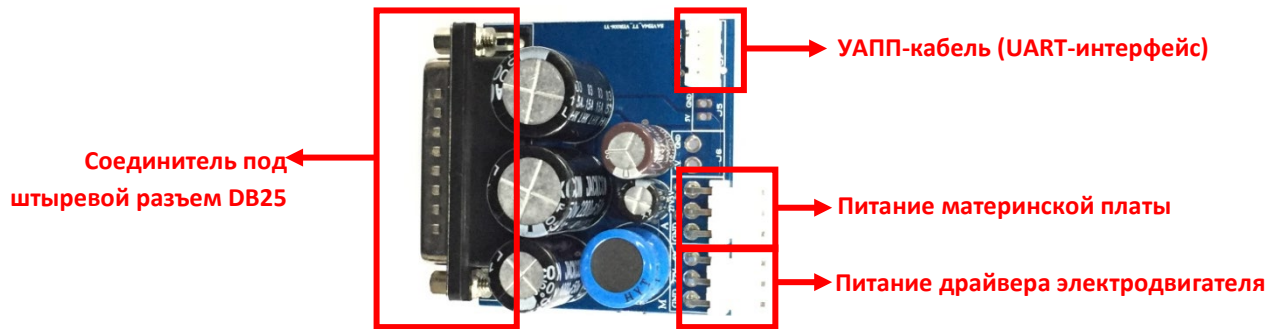
Рис. 39: Разъемы на коммуникационной плате блока управления
