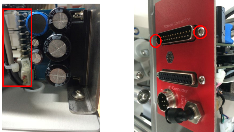
Рис. 33: Замена коммуникационной платы блока управления
