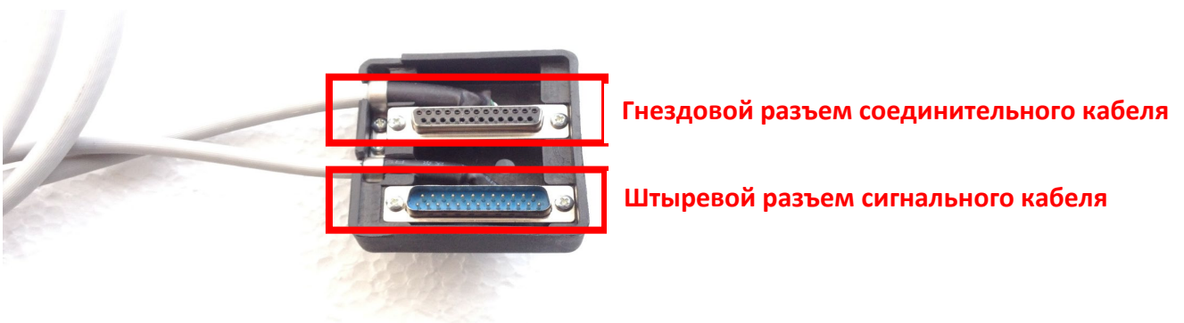
Рис. 16: Разъемы на соединительном сигнальном кабеле
