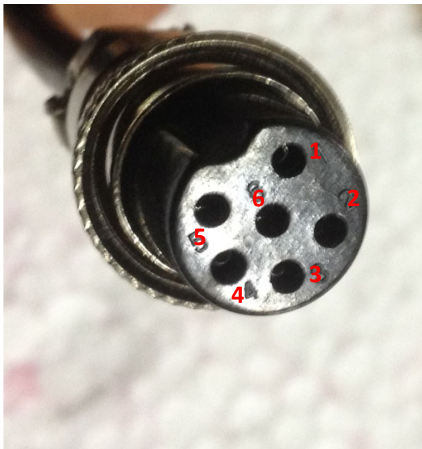
Рис. 14: Распиновка (назначение контактов) кабеля энкодера
