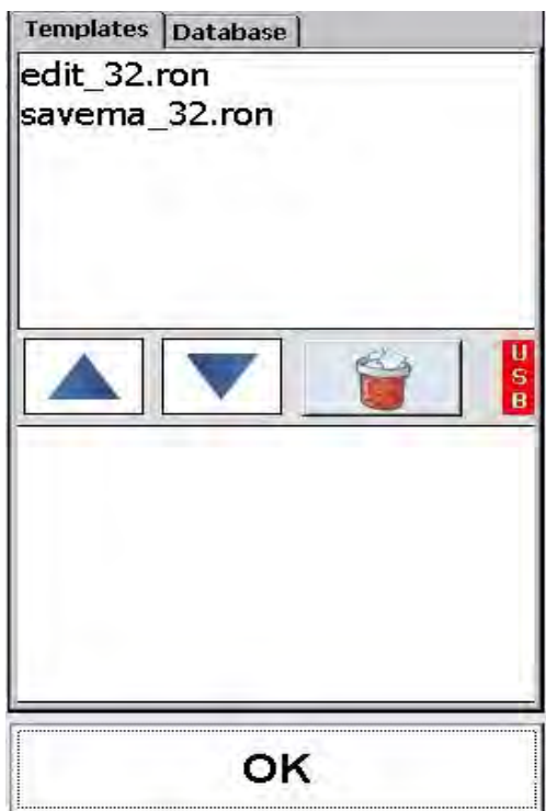
Рис. 3.25. Вкладка «Templates»: передача файлов с макетами маркировок между USB-накопителем и внутр. памятью принтера
