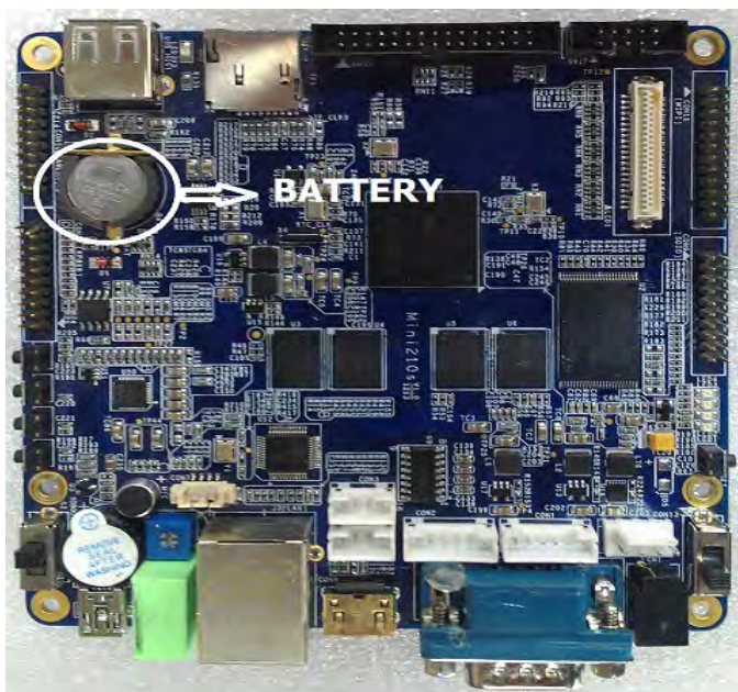
Рис. 3.32. Батарейка часов реального времени
