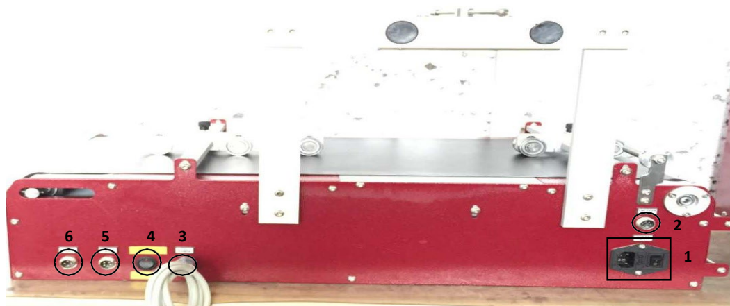
Рисунок 3. Переключатели и разъемы на задней панели ленточного конвейера
