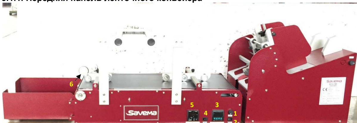
Рисунок 2. Переключатели и кнопки на передней панели ленточного конвейера
