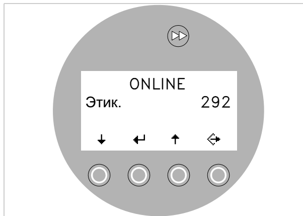
[23] Панель управления в режиме подачи (подано 292 этикетки)
