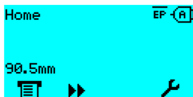
Рис. 41. Вывод значения измеренного шага этикетки (длины этикетки) на дисплей:
