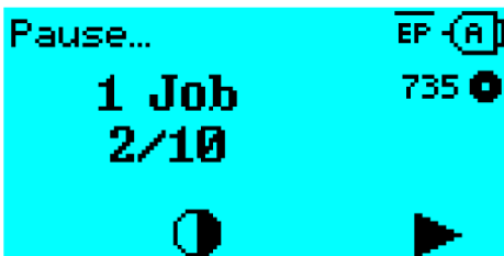
Рис. 52. Приостановленное задание печати (состояние Pause [Пауза]). Нажмите на кнопку «4», чтобы продолжить печать
