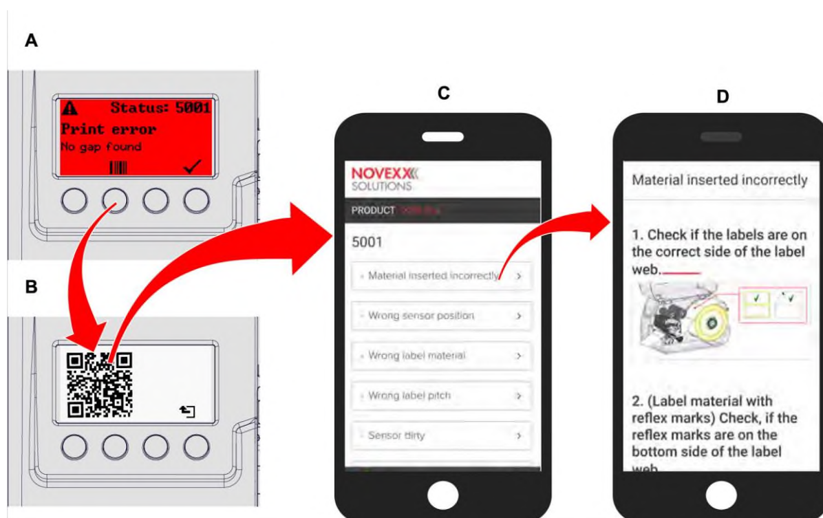
Рис. 57. Если в сообщении об ошибке имеется значок штрихкода (A), то для того, чтобы вызвать на смартфон инструкцию по поиску и устранению неисправностей (C) можно использовать QR-код (B).
