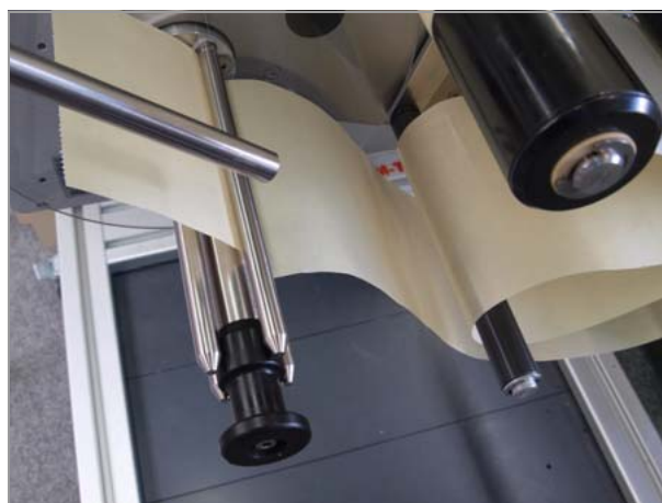
[45] Заправить конец бумаги-носителя на намотчике.
