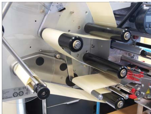
[44] Прохождение этикеточной ленты на намотчике.
