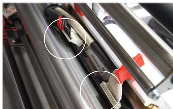
[101] Уложить соединительные кабели таким образом, чтобы они не касались пленки.
