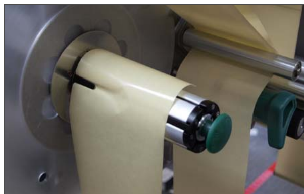
[63] Зажать бумажную основу на намотчике.
