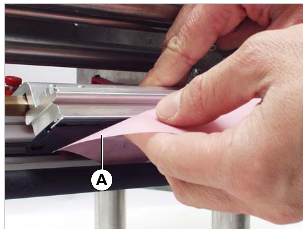
[96] Очистить печатную головку с помощью чистящей ленты.
