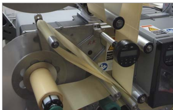
[62] Провести бумажную основу вокруг кронштейна компенсирующего ролика и направляющих роликов.
