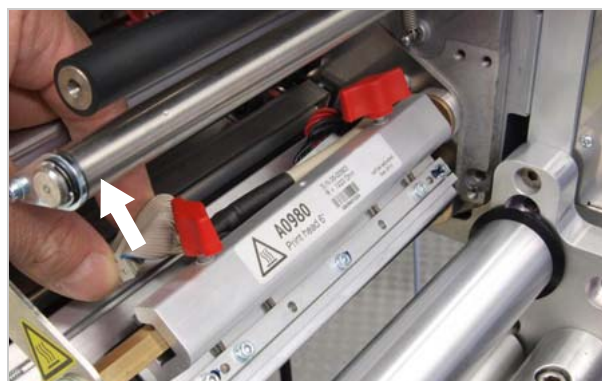
[99] Отсоединить соединительный кабель.
