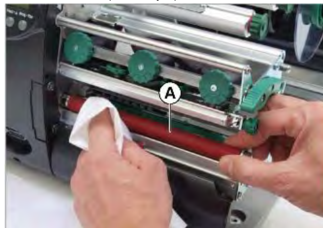
Рис. 10. Очистка печатного вала
