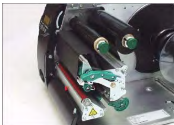
Рис. 18. Фиксация риббона на принимающей катушке и разглаживание складок.
