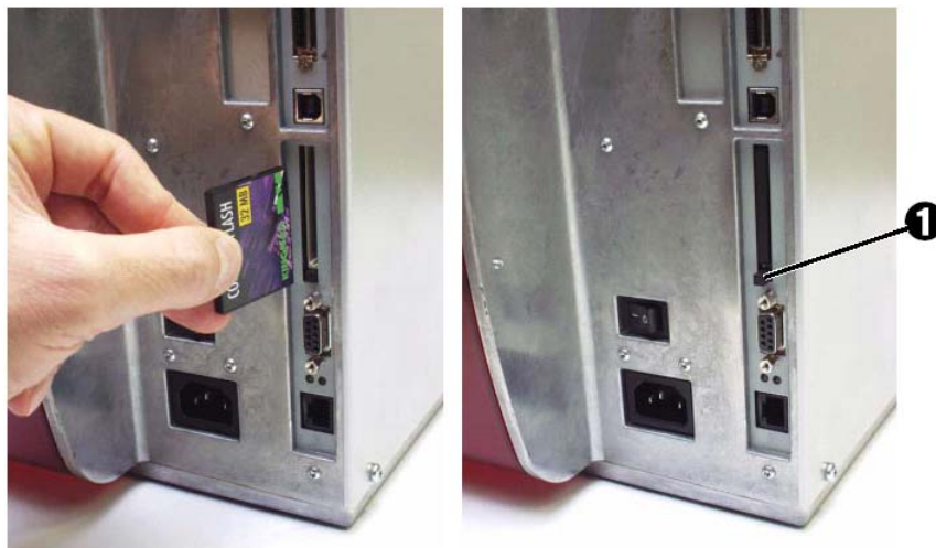
Рис.7: Установка CF карты. Если CF карта установлена корректно, она совпадает с задней поверхностью корпуса устройства (справа).
