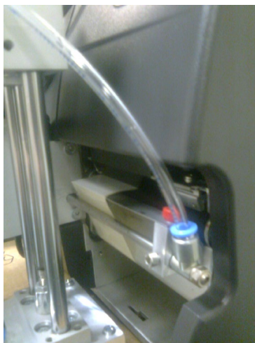
Рис. 5 Рулон с этикетками на ноже диспенсера, под трубкой воздуходува.
