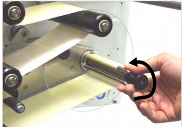
Рис. 14. Вращение сердечника подмотчика, чтобы натянуть подложку.
