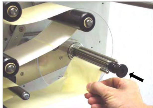
Рис. 13. Закрепление конца ленты на сердечнике подмотчика.
