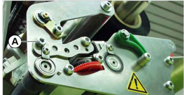
Рис. 12. А Винт, фиксирующий направляющую секцию
