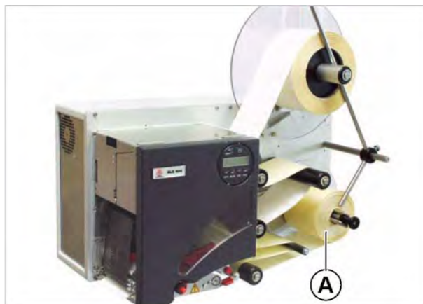
Рис. 1. Смотанная подложка (А) на подмотчике в ALX92x.
