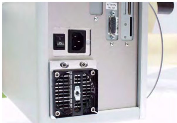
Рис. 29. Держатель фильтра снят.
