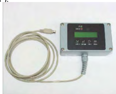
Рис. 3 Внешняя панель управления (справа).
