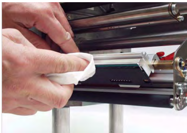
Рис. 6. Очистка печатающей головки с помощью спиртосодержащего растворителя
