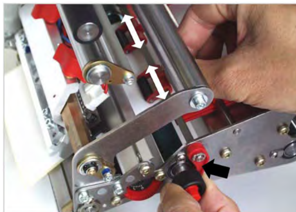
Рис. 7. Регулировка положения прижимных валиков.
