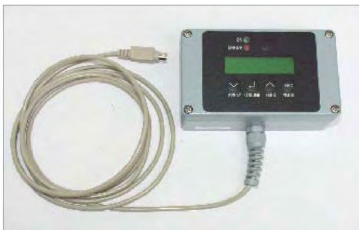
Рис.6. Выносная панель управления (артикул A8293)
