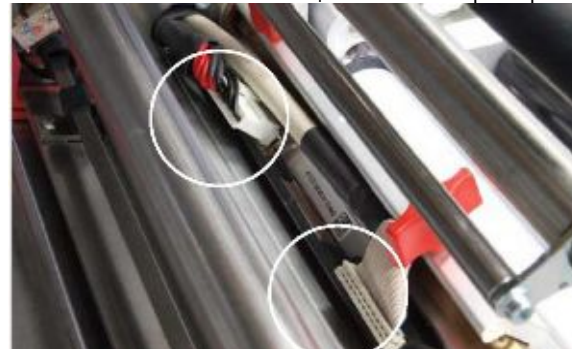
Рис. 11. Уложите кабели печатающей головки так, чтобы они не соприкасались с риббоном.
