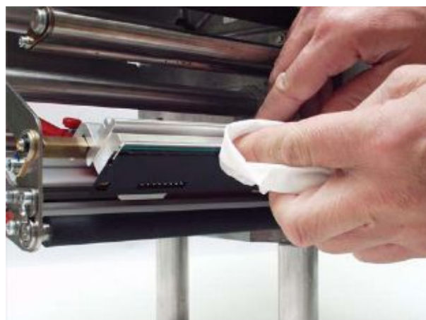
Рис. 7. Очистка печатающей головки спиртом
