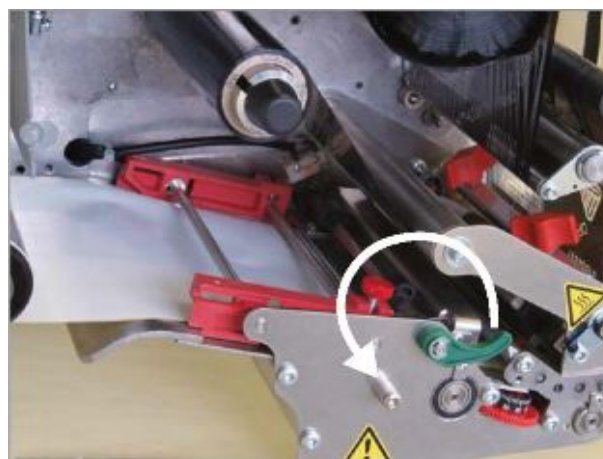
Рис. 12. Опустите рычаг, управляющий поднятием прижимного валика.
