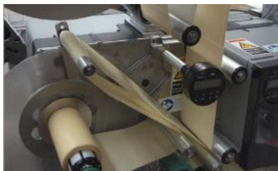
Рис. 17. Протяните ленту вокруг плавающего рычага и направляющего валика.
