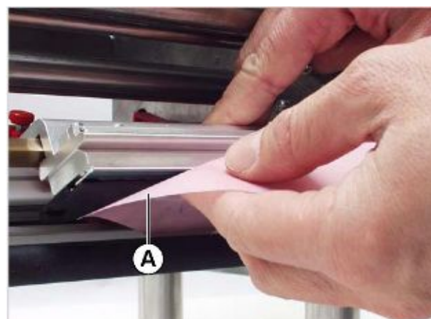
Рис. 6. Очистка печатающей головки чистящими полосками
