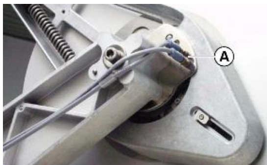
Рис. 5. Место подсоединения (А) проводов на размотчике для датчиков системы внутреннего контроля внешнего диаметра рулона
