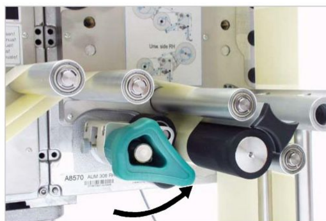
Рис.[40] Возврат прижимного ролика в исходное положение
