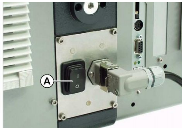
Рис. [30] Сетевой переключатель (A) на задней панели аппликатора
