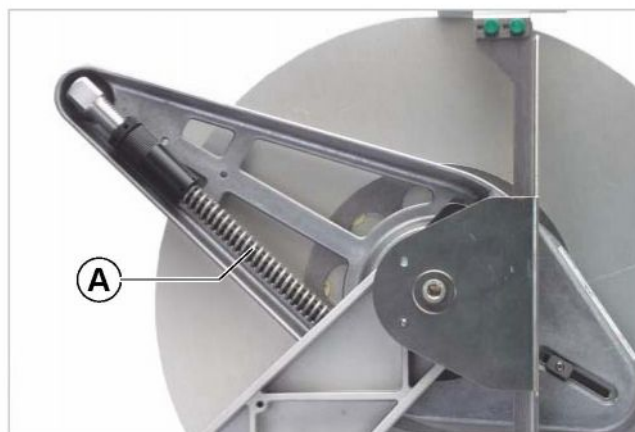
Рис.[47] Возвратная пружина (А) в плавающем рычаге размотчика.
