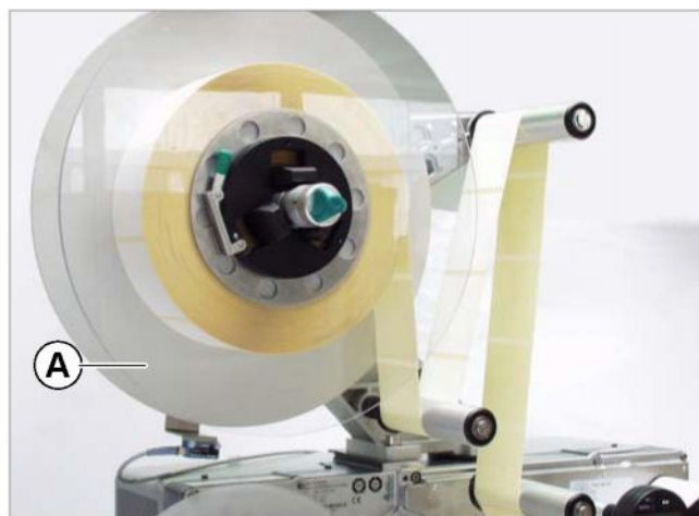
Рис.[16] Дополнительный диск размотчика (А)
