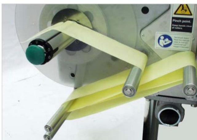
Рис.[41] Протяжка подложки к сердечнику намотчика через направляющие валики и плавающий рычаг.
