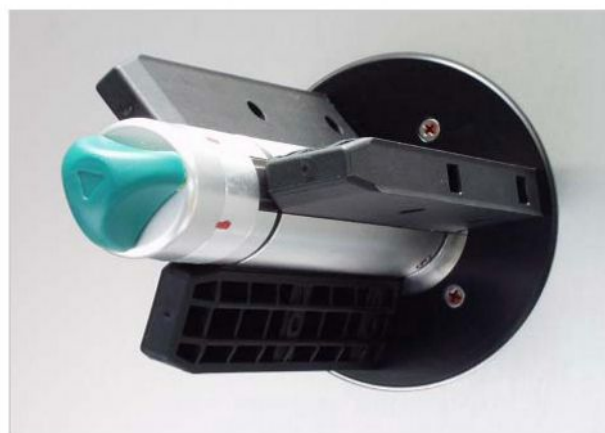
Рис.[44] Положение адаптеров для рулона с втулкой \varnothing 101,6 мм.
