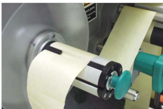
Рис.[42] Закрепление подложки на сердечнике намотчика.
