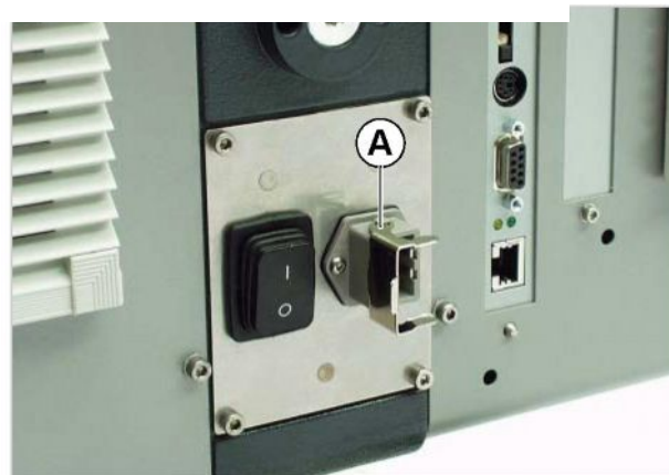
Рис.[25] Разъем (А) для сетевого шнура
