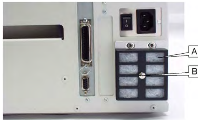
Рис.7. Принтер 64-08, вид сзади. Пылевой фильтр (А).
