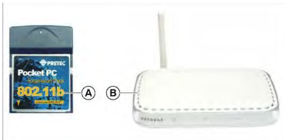
Рис. 10. Беспроводная CF карта (А); Точка беспроводного доступа (В).
