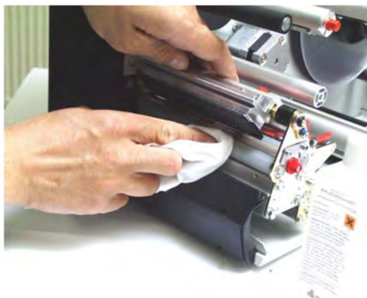
Рис.4. Прежде чем начать очистку, поверните печатающую головку кверху.
