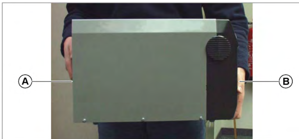
Рис. 5. Безопасная переноска принтера 64-xx: поддерживайте принтер за паз подачи (А) и за нижнее основание (В).
