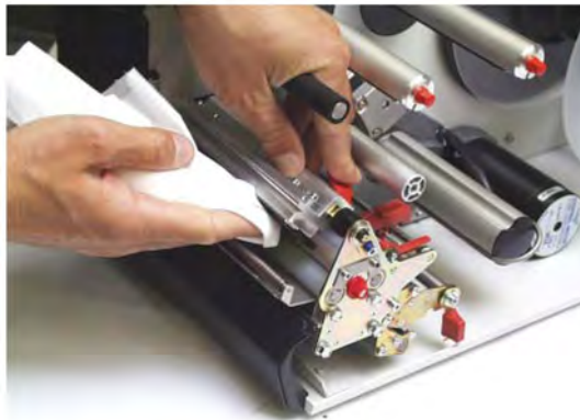
Рис. 1. Очистка печатающей головки – отсоединять кабель печатающей головки не нужно (на рисунке – принтер с диспенсером).
