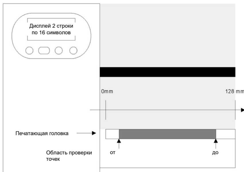
Рис. 18. Схема печатающей головки и определение границ области проверки точек (=Dottestarea)
