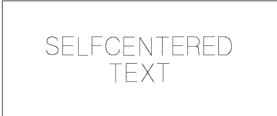
Рис. 71 – Текст, отцентрированный по осям X и Y с помощью функции Самоцентрирование.
